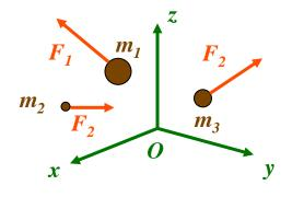
$$M\vec{a}_{com} = m_1\vec{a}_1 + m_2\vec{a}_2 + m_3\vec{a}_3 + \dots + m_n\vec{a}_n.$$
